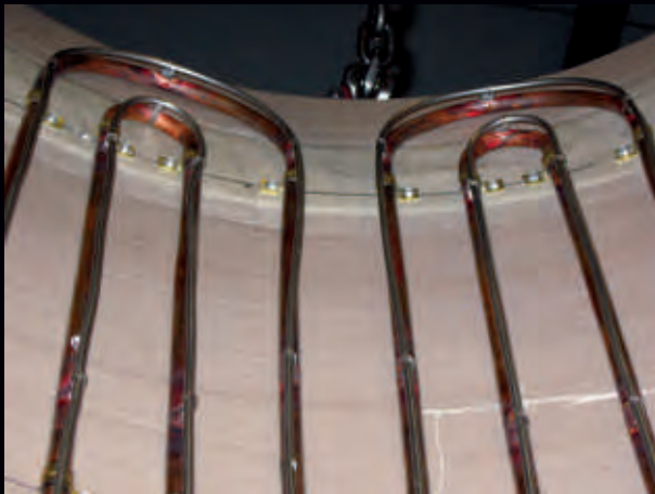
Hitzeschild des Graphitisierungsofens, Sensor Typ 1
