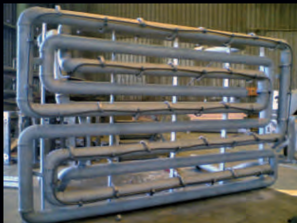
Sensorinstallation am Kühlwassersystem eines Kupferblocks vor dem Eingießen
