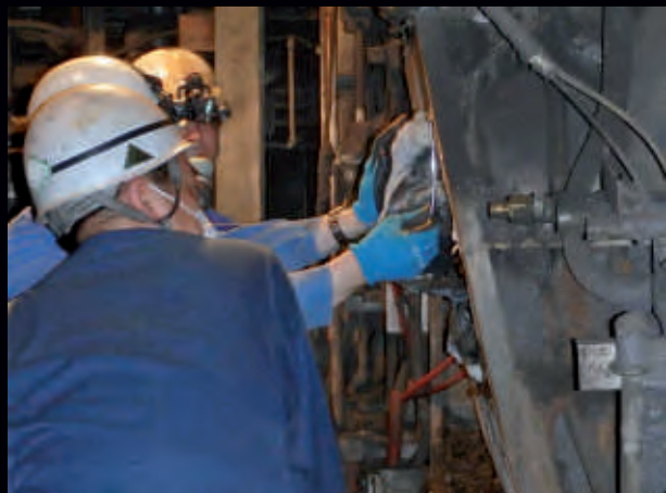
Ausbruch und Bestätigung des angezeigten Verschleißes im Rinneninduktionsofen
