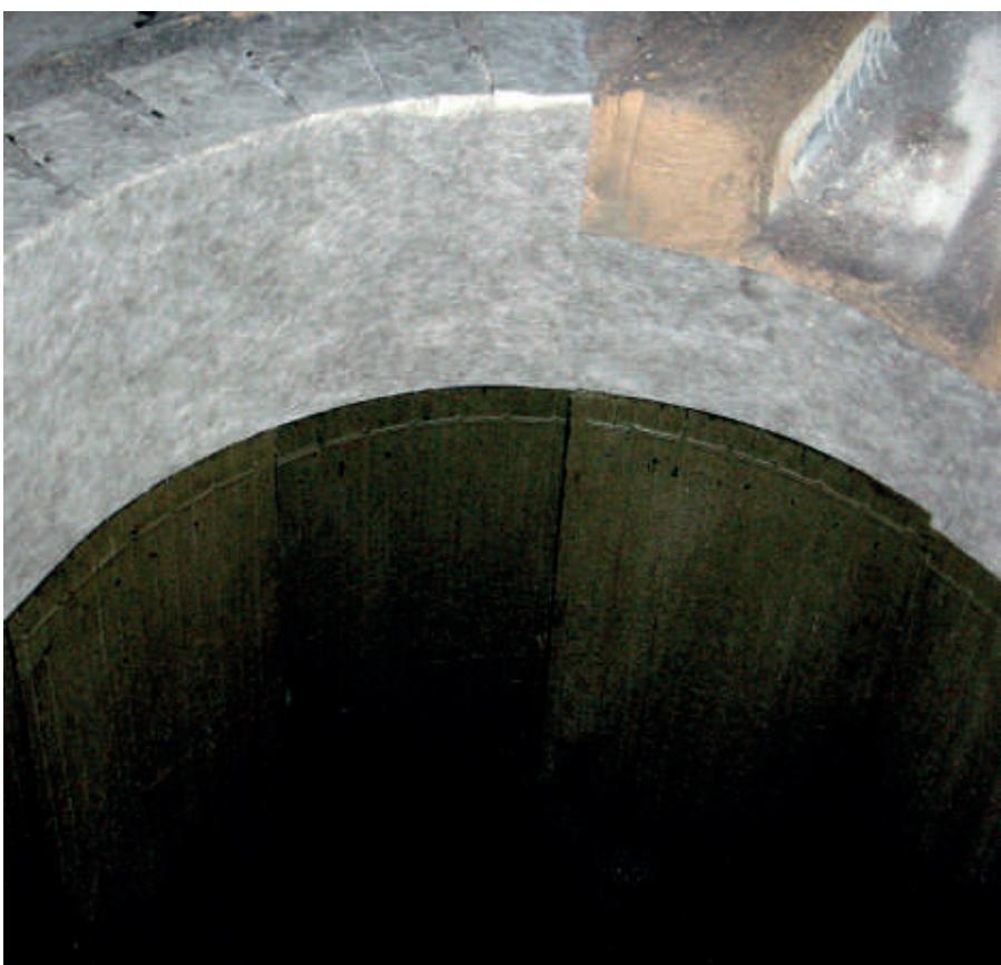
▲ Инсталлированные электродные пластины в индукционной тигельной печи
