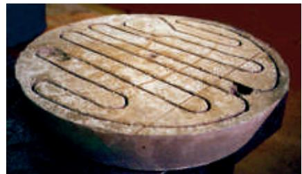
▲ Подготовленный выталкиватель для монтажа датчиков SAVELINE
