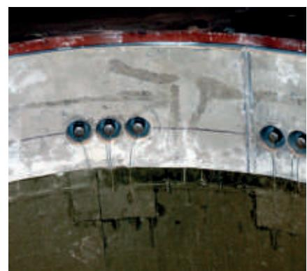
▲ Инсталляция электродных пластин в индукционной тигельной печи
