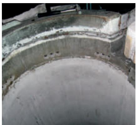
▲ Инсталляция контактных болтов SAVEWAY в верхней части печи
