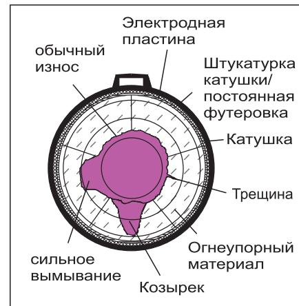
▲ Различные состояния износа в индукционной тигельной печи
