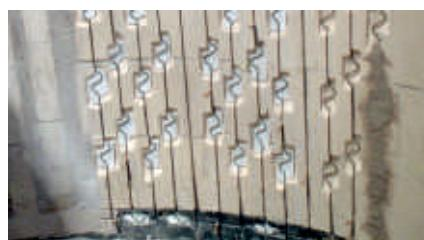
▲ Установка электродных пластин в сталеплавильном ковше
