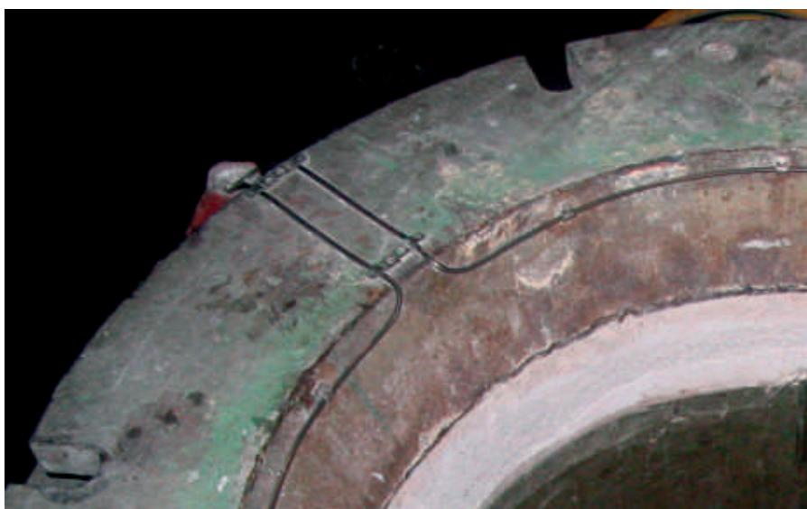
▲ Тигельный индуктор печи оснащенный датчиками SAVELINE для контроля зоны фланца
