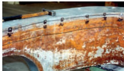
▲ Сенсоры SAVELINE установленные в зоне фланца индуктора
