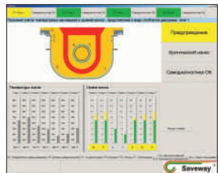
▲ Представление состояния износа на мониторе
