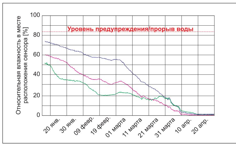
▲ Процесс сушки огнеупорного материала, измеренный сенсором SAVEDRY
